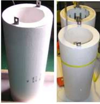
Fig4. 除害ヒータ 復元再生修理
