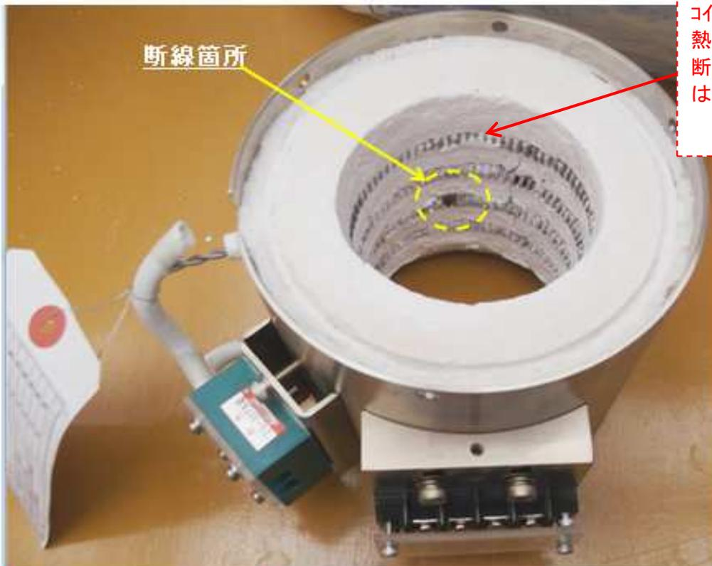
コイル内部の断熱片が除去されていない為、熱効率が劣る。断熱片が剥離しやすく、半導体装置用としては、.....。
